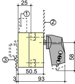
3. 对称DIN导轨式线架上安装固定夹
